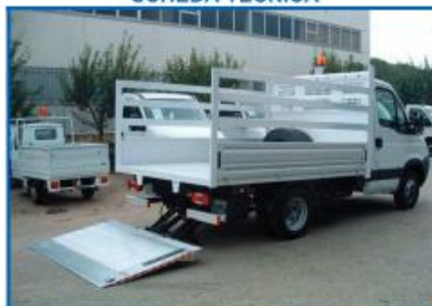
ATTREZZATURA TIPO CASSONE RIBALTABILE BILATERALE CON GRU E PEDANA POSTERIORE RETRATTILE
